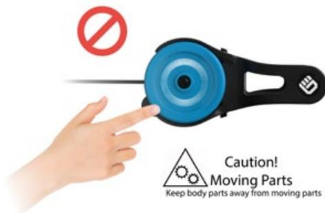
c) No acerque ninguna parte del cuerpo a menos de 10cm de los discos inerciales. Existe la excepción de que cuando use acoplado a la máquina el mango ergonómico, la mano que agarra la máquina esté a menos de 10 cm del disco. De todas formas, esta mano nunca ha de estar a menos de 2,5 cm del disco, y siempre asiendo el mango por su parte interior, de modo que la mano queda protegida por la estructura del mango ergonómico.
