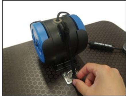
**5)** Mueva el distanciador de seguridad hasta estar próximo a la boquilla de la máquina.
